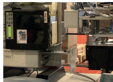
Bei der KLT-Kommissionierung wo früher Personen bis zu 20 Tonnen am Tag heben mussten werden die KLT-Boxen auch etikettiert
