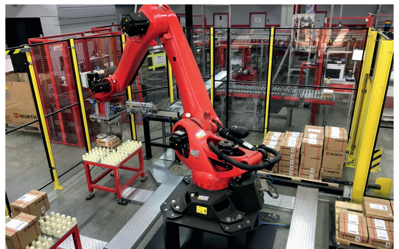
Bei der Paketpalettierung werden 5 verschiedene Kartontypen nach einer 3D-Scannung nach Schlichtmuster abgelegt
