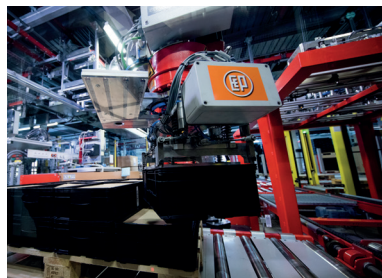
Bei der KLT-Kommissionierung wo früher Personen bis zu 20 Tonnen am Tag heben mussten werden die KLT-Boxen auch etikettiert
