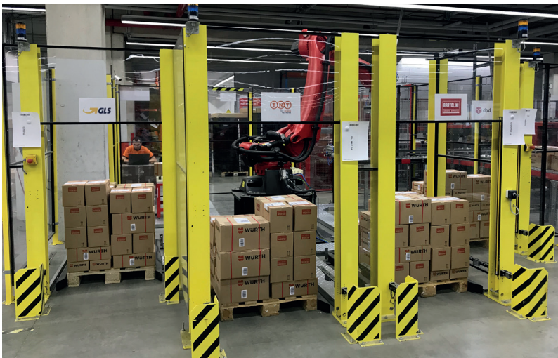
Bei der Paketpalettierung werden 5 verschiedene Kartontypen nach einer 3D-Scannung nach Schlichtmuster abgelegt
