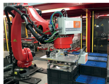
Bei der Versandpalettierung arbeiten 2 KUKA KR180 R3200 PA
